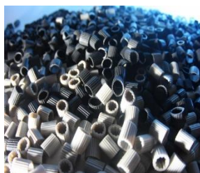
Figure 4: Le support «Pearl» sur lequel se forme le biofilm
